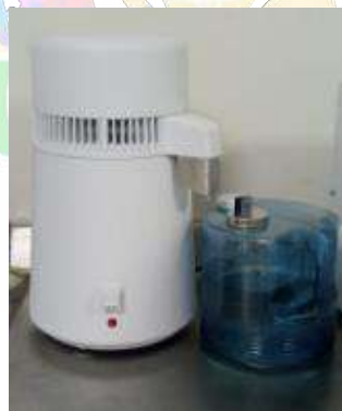
Registro fotográfico: Instalación de Destilador de agua - Odontología
